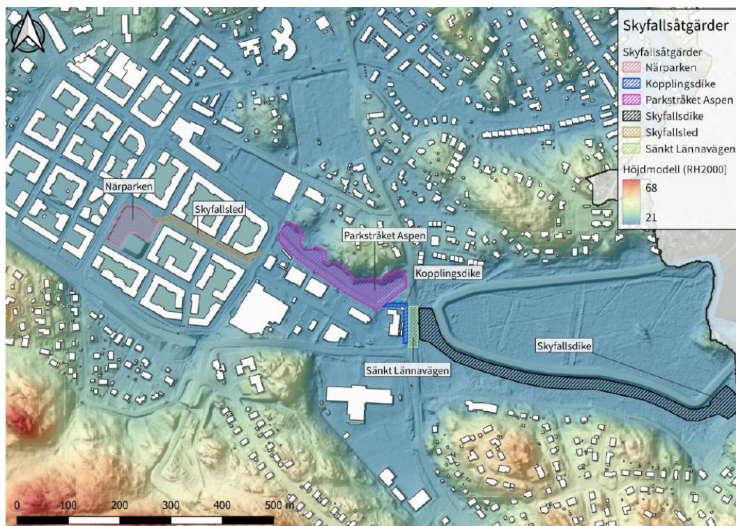
Figur 36. Planerade skyfallsåtgärder inom Storängen (Översvämning och skyfall i Storängen, 2024).
