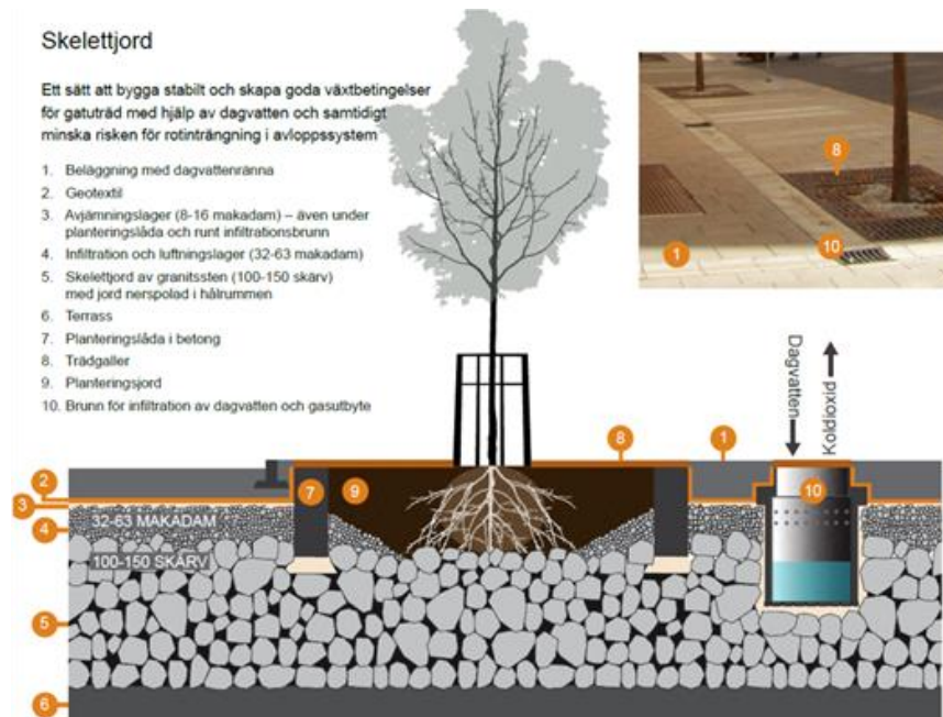
Figur 11-2. Schematisk illustration över plantering av träd i skelettjord (Stockholm Vatten och Avfall, 2021a).
