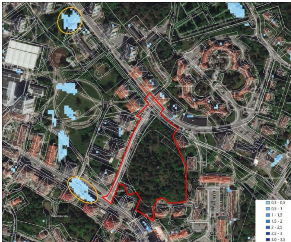
Figur 19: Översvämningssituationen inom och utanför planområdet. Bilden visar vilka områden som har ett stående vattendjup på mer än 30 cm vid ett 100-årsregn. Källa: WSP.
