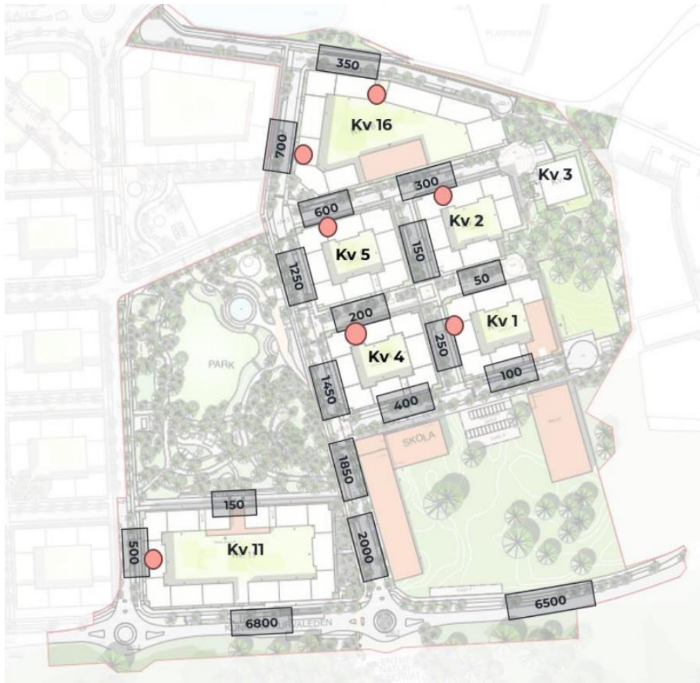
Figur 3. Trafikflöden på gatorna inom området utifrån den uppdaterade situationsplanen. Flödena utgörs av årsdygnsflöden (ÅDT) och är en justering av flödena framtagna i tidigare trafikutredning daterad 2020-12-15, scenario "UA2, 2040 normal". De rosa cirkelarna utgör in- och utfarter från parkeringsgarage.
