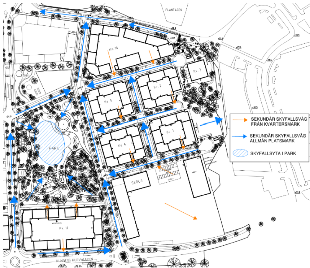
Schematisk bild som visar hur vattnet kommer att rinna inom detaljplaneområdet vid ett skyfall. Illustration: Structor, Dagvattenutredning, 2024.
