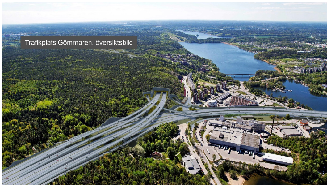
Figur 5: Illustration över Tvärförbindelse Södertörns med vy öster ut. Här redovisas kopplingen mellan E4/E20 och Tvärförbindelse Södertörn. Av- och påkörningsramper från E4/E20 svänger öster ut och in i Masmoberget. Rendering gjord av Trafikverket.
