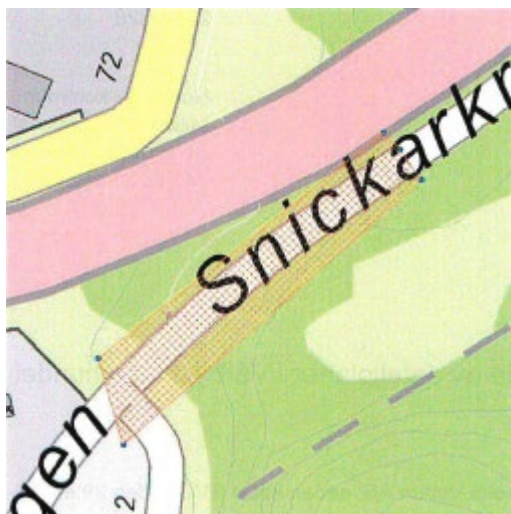
Bild 1: Område med befintliga VA-ledningar som kan tas ur drift.
