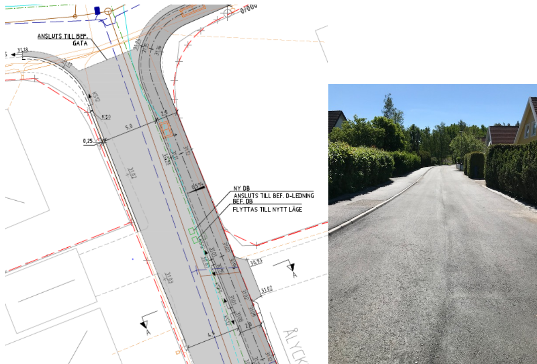
Figur 11. Utdrag ur projekteringsritning för gatan samt foto på färdigbyggd gata.
