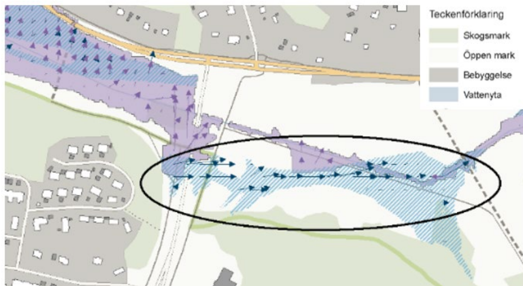
Figur 16. Förändring av översvänningsområden som en följd av att Tvärförbindelse Södertörn byggs. Lila markerat område visar översvänningsområde vid ett 100-årsregn för nuläget och blårandigt område visar översvänningsområdet vid 100-årsregn för framtida situation. Lila pilar visar flödesriktning för nuläget och blå pilar visar flödesriktning för framtida situation. (TRV Översvämning PM).
