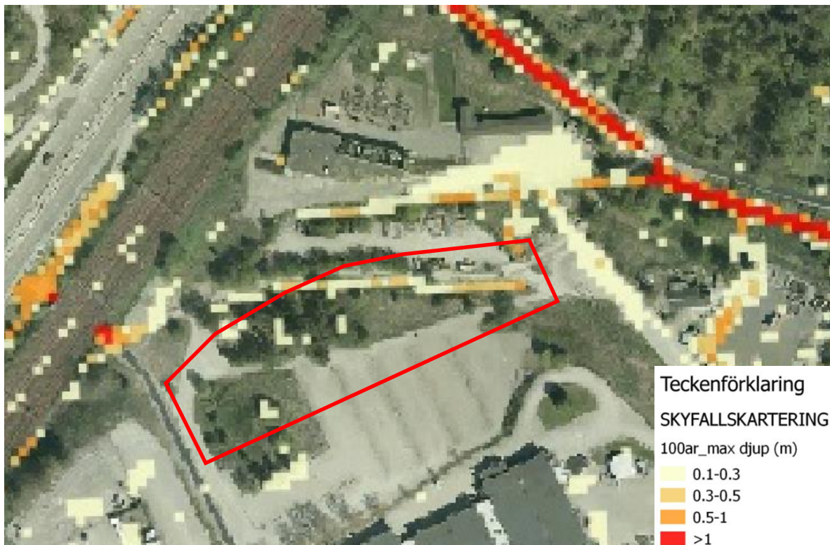
Figur 5-5. Urklipp från WSP:s skyfallskartering (2018-06-19). Bilden visar vilket maxdjup som breder ut sig vid ett 100-årsregn med klimatfaktor. Röd polygon visar det ungefärliga utredningsområdet.
