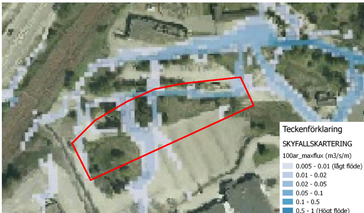
Figur 5-6. Urklipp från WSP:s skyfallskartering (2018-06-19). Bilden visar vilket maxflöde som uppstår vid ett 100-årsregn med klimatfaktor. Röd polygon visar det ungefärliga utredningsområdet.
