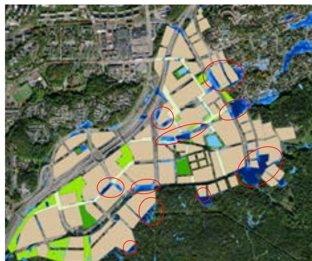
Kartan visar maximala vattendjup i den framtida strukturen under en simulering i en hydrodynamisk skyfallsmodell av ett 100-årsregn med klimatfaktor och 4 timmars varaktighet utifrån avrinningsområdets storlek. Källa: Norconsult Skyfallsutredning för Kungens kurva 2023
