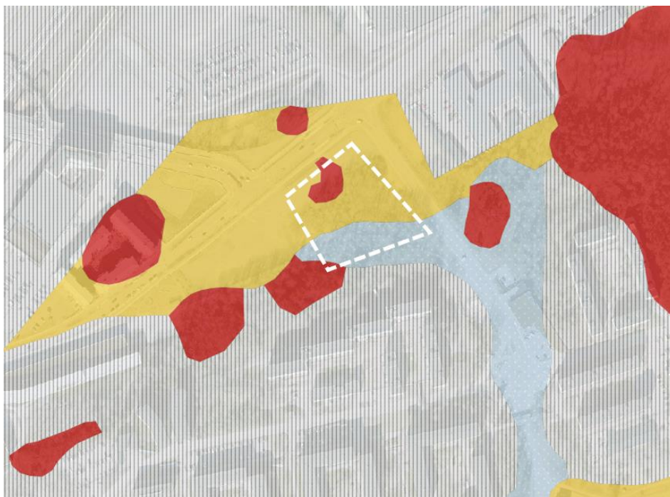
Utdrag från SGU:s jordartskarta. Skrafferad yta visar fyllning, prickad yta visar morän, gul färg visar postglacial lera och röd färg visar berg. Vit markering visar planområdet.
