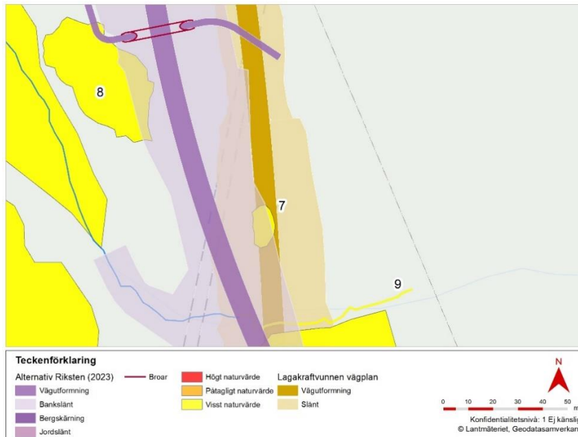
Figur 37. Småvatten (objekt 7) som bedöms komma att påverkas av dagvattenlösning och nytt vägområde.
