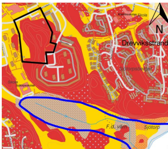
Figur 2. Jordartskarta (SGU 2016-10-11). Planområdet markerat inom svart polygon. Röd färg markerar urberg, gul färg glacial lera, prickigt område mot beige bakgrund visar kärrtorv. Området inom blå linje markerar ungefärlig avgränsning av utströmningsområdet
