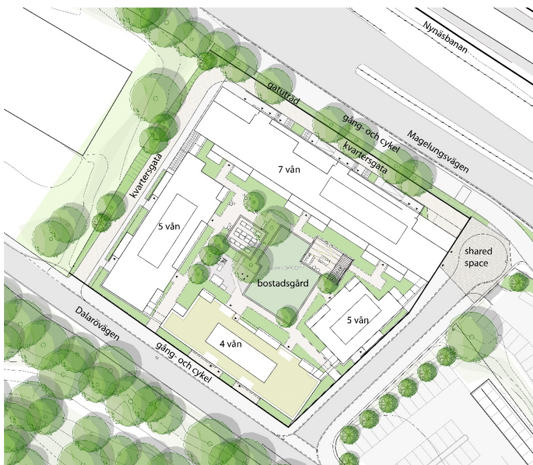
Figur 02. Vision över hur bebyggelsen kan utformas enligt plan. Fyra huskroppar sammanlänkade med hushöga glasväggar som kombineras med balkonger. Bild: ÅWL Arkitekter/Huddinge kommun.
