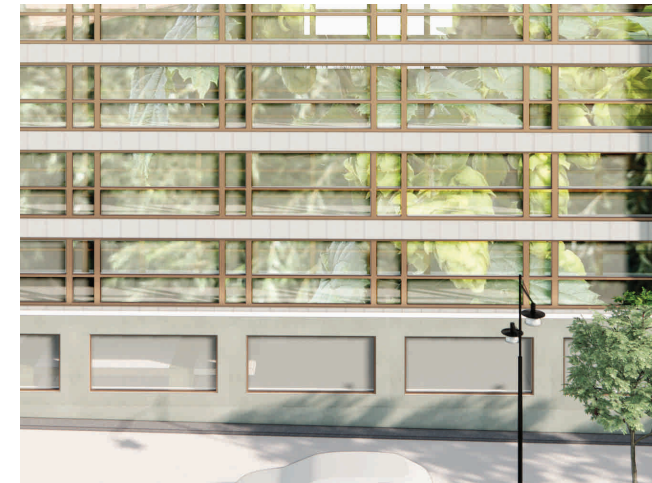
Exempel på screentryckt bullerskärm
