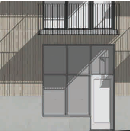
Träfasad möter betongsockel och uppglasad entré.
