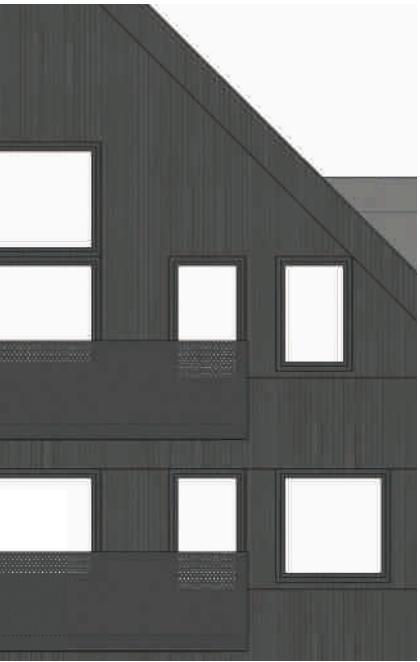
Refiefverkan i horisontella band. Balkongräcken med genomsiktig front av perforerad plåt.
