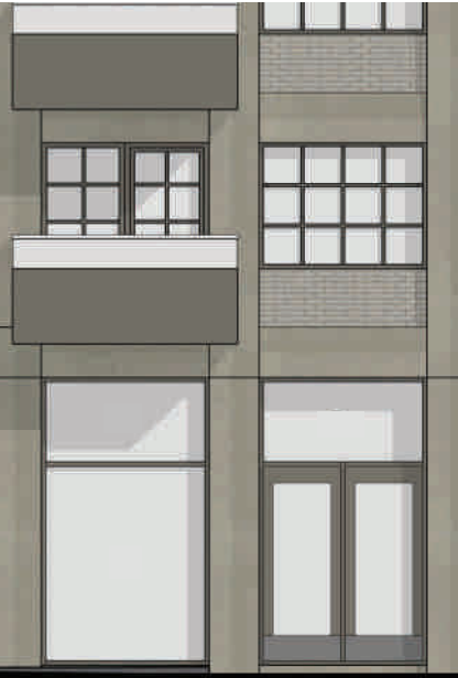
Sockelvåning i betong med markerat entréparti och generösa fönsterpartier till lokaler. Utsnitt fasad i tegel med relief i betong och industrifönster med tät spröjs.
