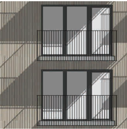
Träfasad med pinnräcke och fönster till golv.
