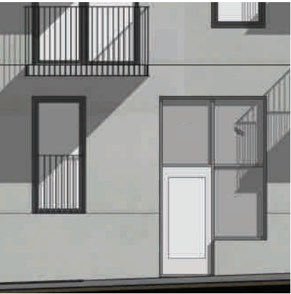
Betongfasad fortsätter ner i sockel.
