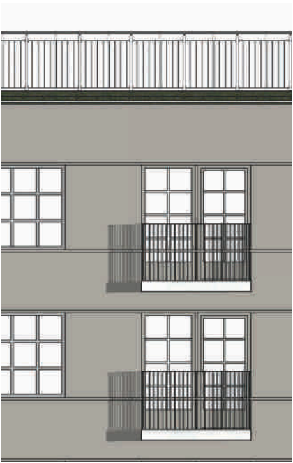
Plåtfasad med liggande relief. Fönster med industrikaraktär & balkonger med pinnräcke.
