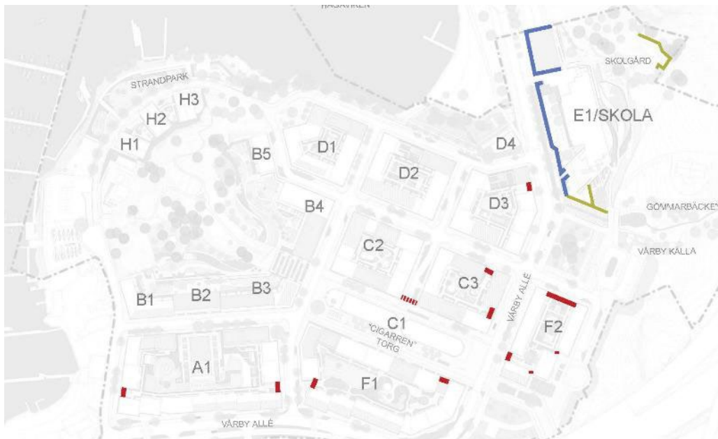
Figur 77. Illustration som redovisar föreslagna hushöga bullerskärmar i röd heldragen linje, hushöga temporära skärmar i streckad röd linje, och bullerskärmar om 4 meter höjd (gul linje) respektive 3 meter höjd (blå linje).
