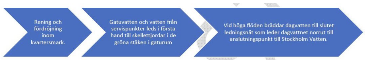
Figur 19. Flödesschema dagvattenhantering efter planerad exploatering (Structor, 2018)
