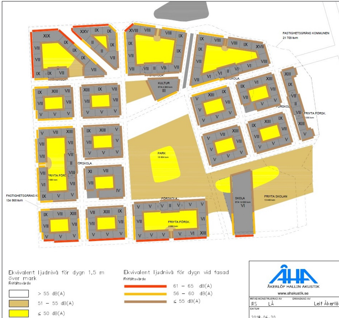
Figur 21. Ekvivalent ljudnivå vid fasad samt 1,5 m ovan mark för våning 1-10. Åkerlöf Hallin Akustikkonsult, 2018.
