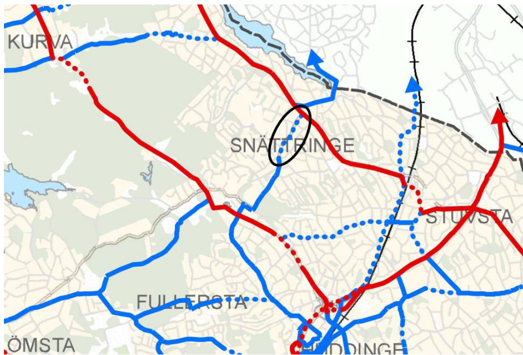
Utepkade cykelstråk i Huddinges cykelplan. Röda länkar utgör regionala cykelstråk, blåa länkar utgör huvudcykelstråk. Saknad länk längs Lönnvägen mellan Ängshyddevägen och Häradsvägen inringad i svart.
