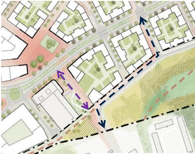
Utsnitt från översynen av planprogrammet för Flemingsbergsdalen. Ny föreslagen dragning av Kvarnäingsvägen är enligt svart streckad linje. Sista delen av den befintliga Kvarnäingsvägen föreslås bli gång- och cykelskoppling/parkstråk (lila streckad linje).
