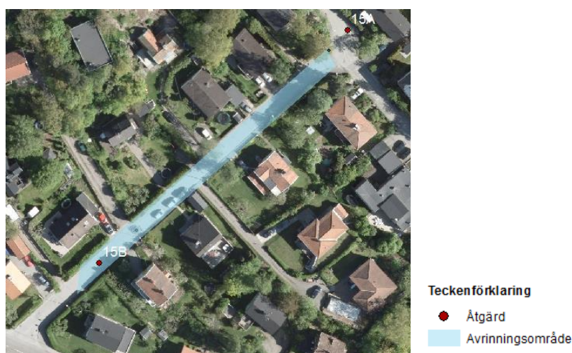
Figur 30. Avrinningsområde till nedsänkta växtbäddar på båda sidor av Gullrisstigen.
