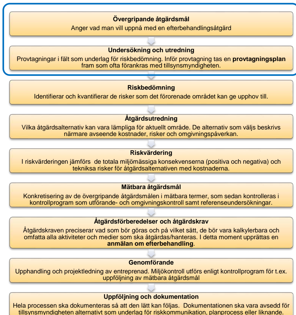
Figur 1.1 Schematisk beskrivning av utrednings- och efterbehandlingsprocessen, där blåmarkering anger de moment som det aktuella objektet har utfört.
