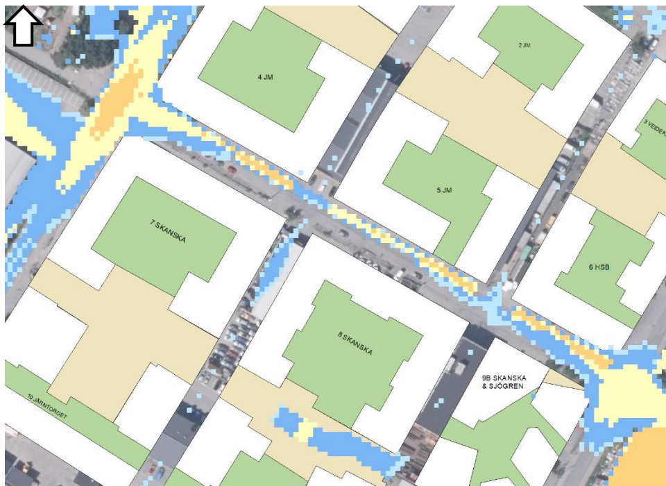
Figur 33. Inzoomad bild på de kritiska vattendjup som beräknas bildas till följd av åtgärdsförslagen. Berörda fastigheter bedöms vara Skanska 7, JM 4, Skanska & Sjögren 9 samt HSB 6. En mindre ansamling syns även vid fastigheten som benämns Skanska 8. Denna bedöms dock inte påverka fastigheten utan har och göra med upplösningen av modellen.
