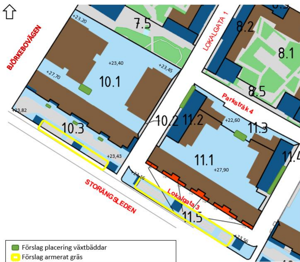
Figur 24. Järntorget's kvarter, delavrinningsområden, plushöjder och förslag på placeringar av växtbäddar och täckta dagvattenstråk. Ofärgade områden är allmän platsmark. Förklaring till färgade områden finns i figur 4. Framställd utifrån underlag från Järntorget och ÅWL Landskap, mottaget mars 2020.
