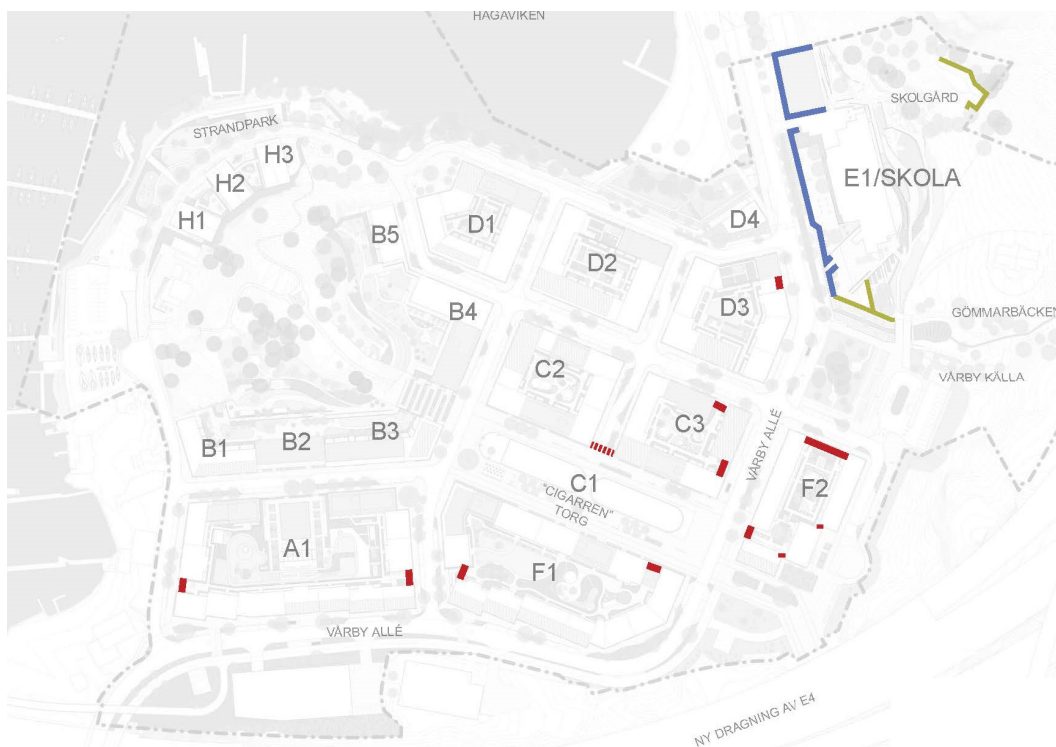
Figur 2, Illustration som redovisar föreslagna hushöga bullerskärmar i röd heldragen linje, hushöga temporära skärmar i streckad röd linje, och bullerskärmar om 4 meter höjd (blå linje) respektive 3 meter höjd (gul linje).
