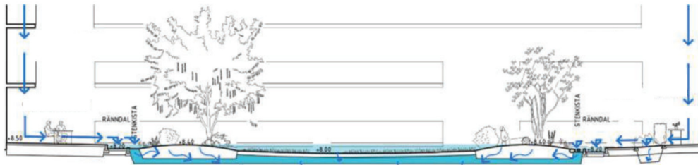
Figur 6-5. Principutformning för dagvattenhantering på innergård. Dagvattnet från hårdgjorda ytor och takytor leds till infiltrationsstråk, som ansluter till ett poröst lager under innergårdens grönytor, varifrån avtappning långsamt sker till dränering ovan bjälklaget.
