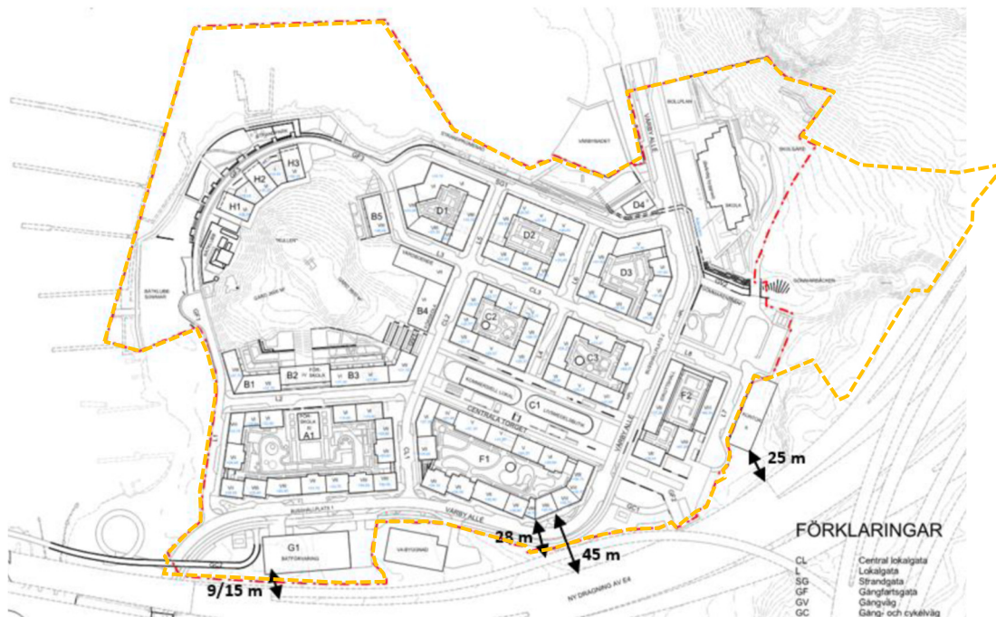
Figur 14, Strukturplan med redovisade avstånd till väggkant (E4/E20) och föreslagen bebyggelse inom detaljplanen. Planområdesgräns illustreras med gul streckad linje.
