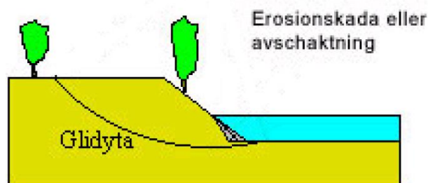
Figur 10: Minskning av mothållande krafter till följd av exempelvis erosion eller avschaktning. Bild hämtad från MSB.se.
