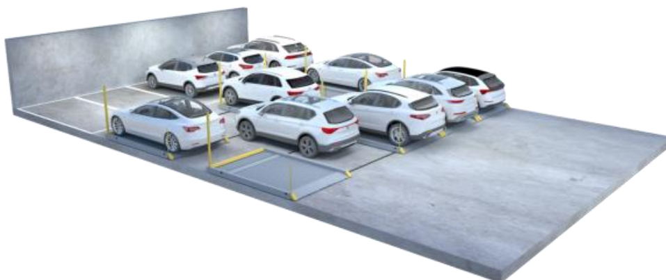
Figur 6-1 Exempel på parkering med plattformar som möjliggör en mer utrymmeseffektiv lösning. De två yttre raderna parkerade bilar på bilden står på plattformar som kan förflyttas i sidled vilket ger access till bilarna som står innerst. Bildkälla: www.metrisk.se
