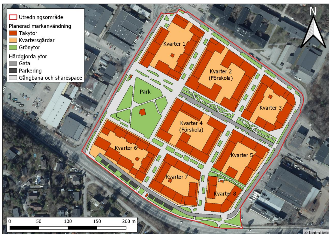
Figur 17. Planerad markanvändning efter exploatering med bland annat en park, lokalgator och åtta kvarter, varav två kommer att ha förskolor. Ortofoto © Lantmäteriet, u.å.
