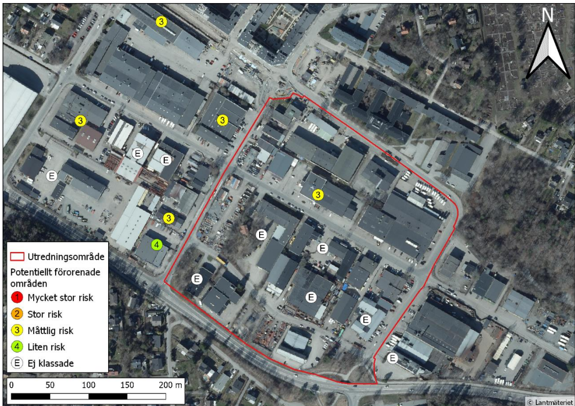
Figur 9. Potentiellt förorenade områden i och i närheten av utredningsområdet (Länsstyrelserna, 2024). Ortofoto: © Lantmäteriet, u.å.
