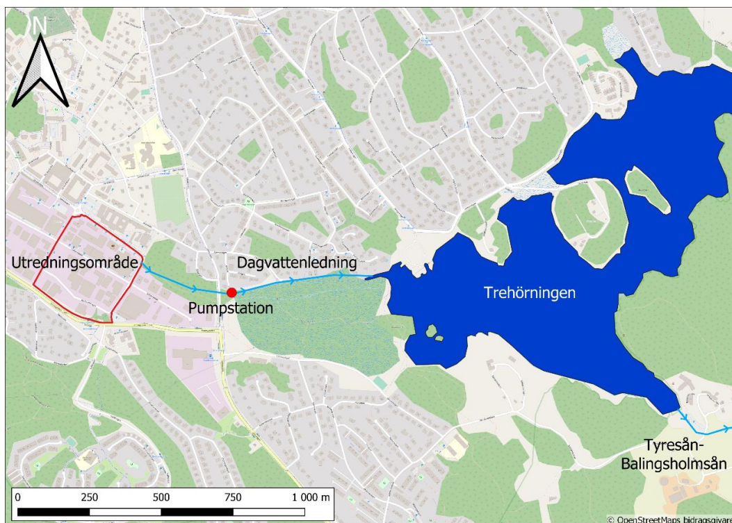
Figur 16. Ytvattenrecipienten Trehörningen öster om utredningsområdet, samt ungefärlig placering av dagvattenledningen och pumpstationen som avleder vatten från området till recipienten. Trehörningen är en del av Tyresån-Balingsholmsåns vattenförekomst. Bakgrundskarta: © OpenStreetMaps bidragsgivare, u.å.
