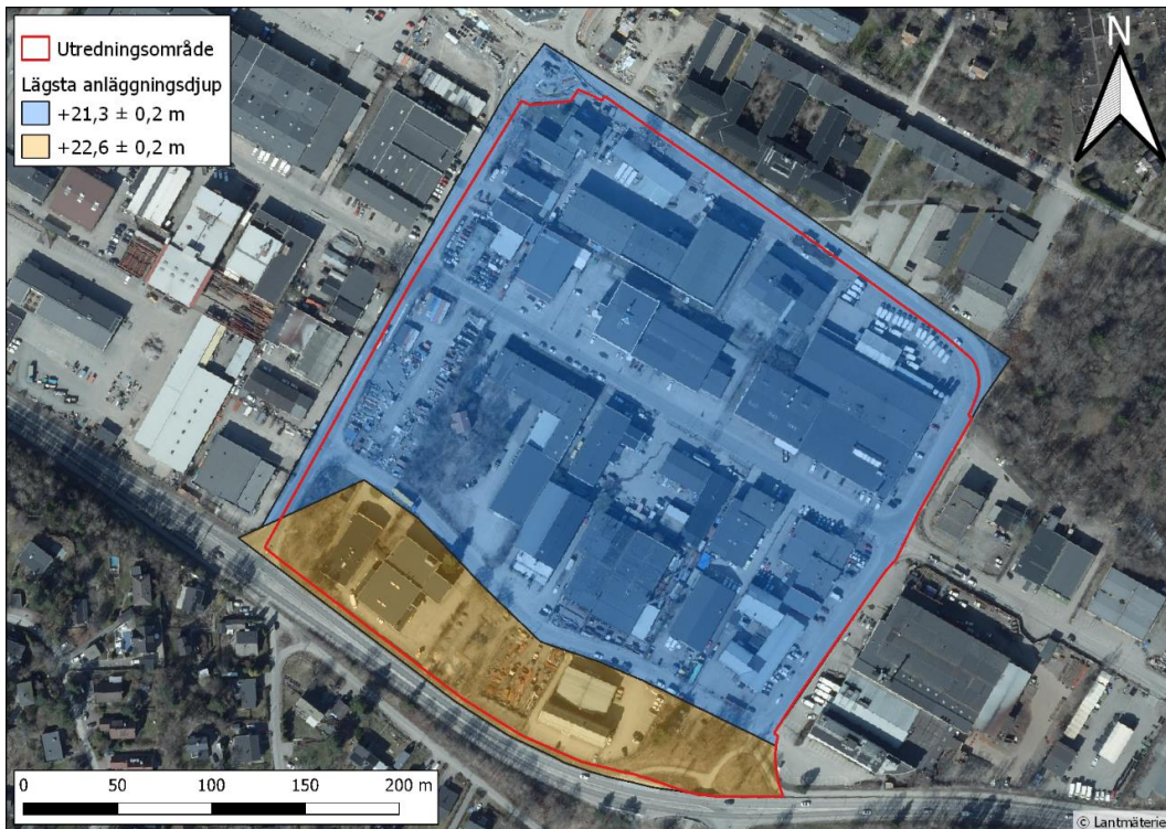
Figur 11. Lägsta rekommenderade anläggningsdjup för dränerande marköverbyggnader i utredningsområdet baserat på geoteknisk utredning för Storängen etapp 4 (Geoteknologi Sverige AB, 2021).
