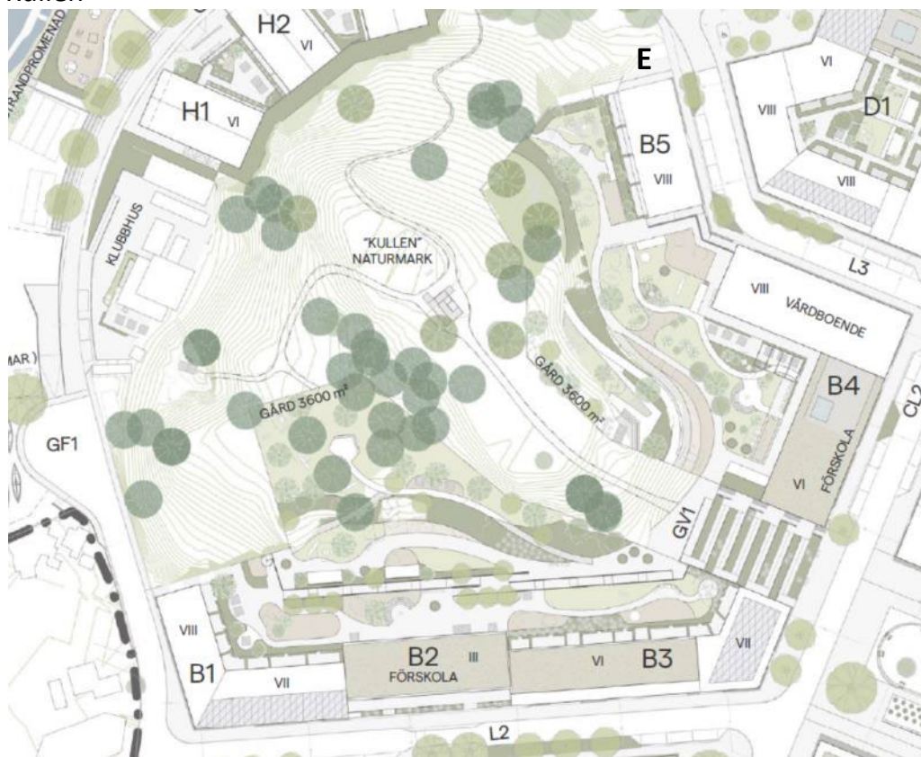
Figur 11, Utsnitt ur Illustrationsplan över kullen med tänkt utformning av bostadshus och förskolor med gårdar, söder och öster om kullen, transformatorstation markeras med E.
