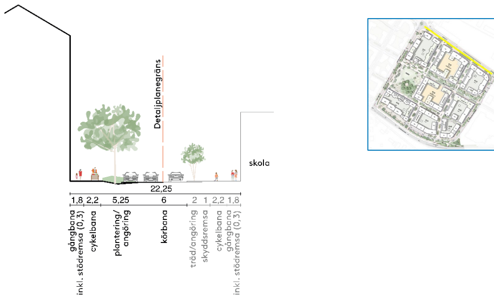
Figur 13 Sektion för Sjödalsvägen i anslutning till planområdet. Källa: Sektionsförslag och strukturskiss: ÅWL arkitekter. Gulmarkering: Trivector.
