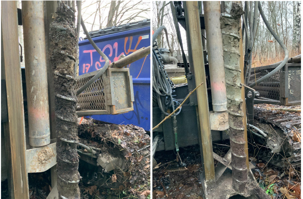
Figur 7-2 Två exempel på skruvborrar, punkt W111 (vänster) med det översta och omrörda fyllningslagret och punkt W129 (höger) med översta lagret av torrskorpelera följt av ett lager mull.
