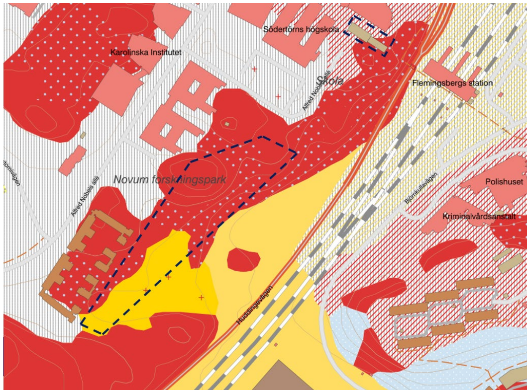
Figur 5, SGU jordartskarta (gult=lera, rött=berg, blåprickigt=tunt moräntäcke, gråskrafferat=fyllning).
