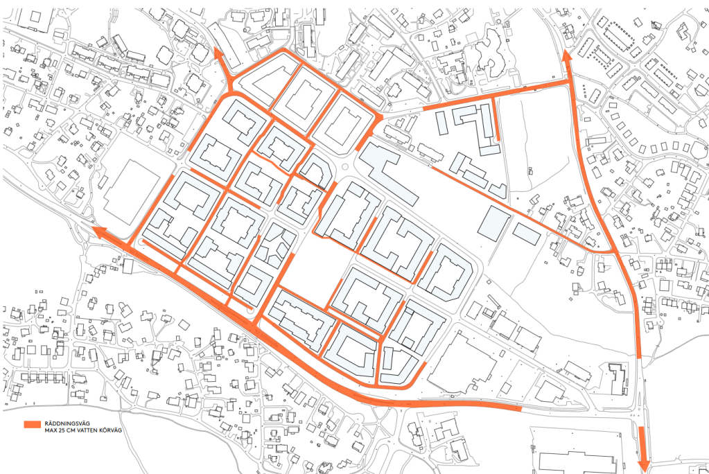
Figur 31. Räddningsvägar vid en BHF-händelse. Orange körvägar har maximalt 25 cm vattendjup och är framkomliga för samtliga fordon. (ÅWL Arkitekter, 2024-03-05)
