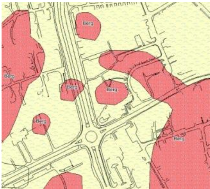
Bild 5: Jordartsskikt över planområdet, cirka 50 centimeter ned i marken (gult = lera, rött = berg).
