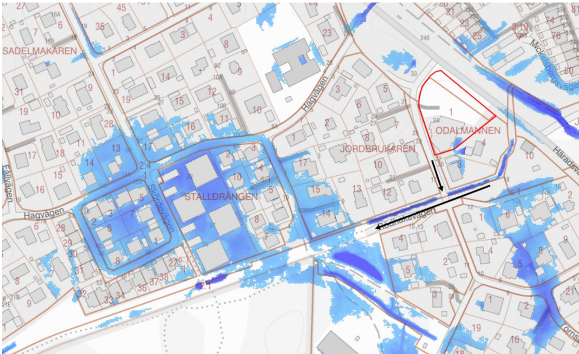
Figur 23 Maximalt vattendjup och flödesvägar nedströms om planområdet vid ett 56 mm regn vid befintlig situation (ScalgoLive 2023). Planområdets gränns markeras med röd linje och flödesinriktning med svarta pilar.
