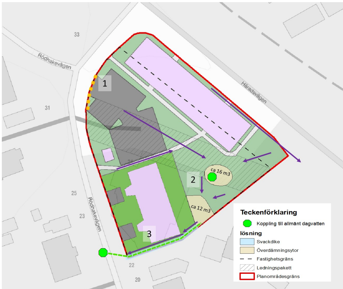
Figur 36 Föreslagna lösningar för skyfallshantering: höjdsättning (1), överdämningsytor (2) och svackdike (3). Orange streckade linjer visar upphöjning av marken för att förhindra ytliga vattenflöden. Lila pilarna visar föreslagna avrinningsvägar till överdämningsytor samt skyfallsväg ut från fastigheten ifall överdämningsytornas kapacitet överstigs.
