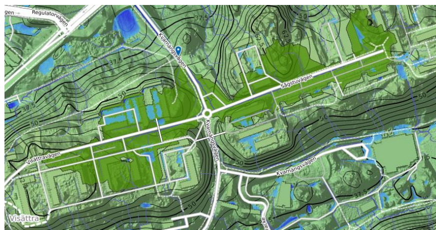
Figur 19 Avrinningsområde som leds om via cirkulationsplatsen mot befintligt dike och Visättraån
