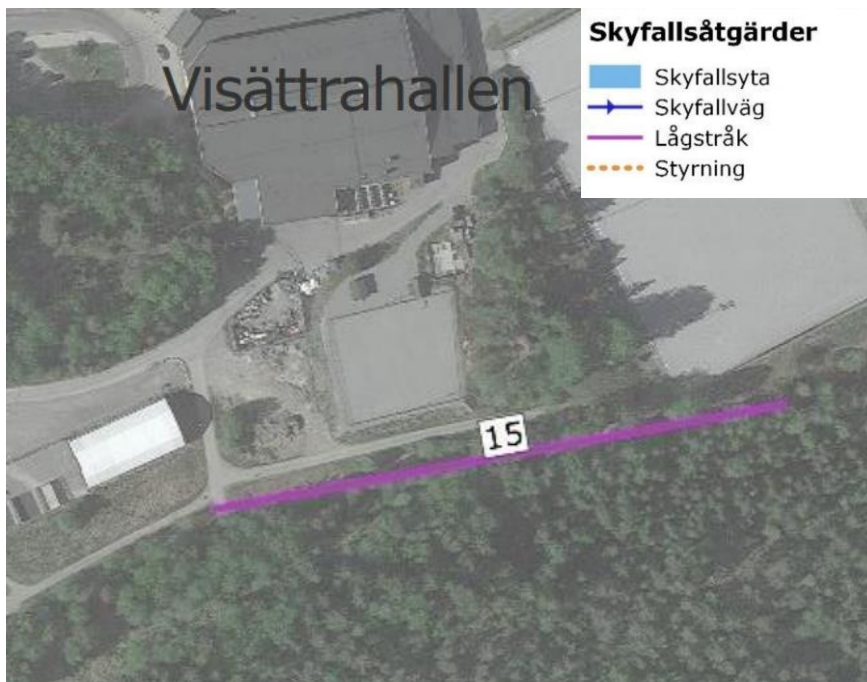
Figur 18 Åtgärdsförslag nr 15 som leder ett skyfall österut istället för mot Björnkullavägen och järnvägen (Ramboll, 2021).
