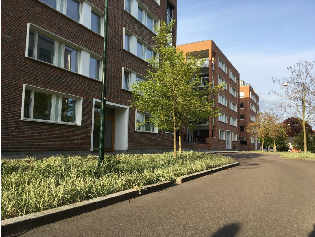
Figur 30. Regnbädd i Folkets park i Malmö. Dagvatten leds till regnbädden via öppning i kantstenen. (Foto: Ramboll)
