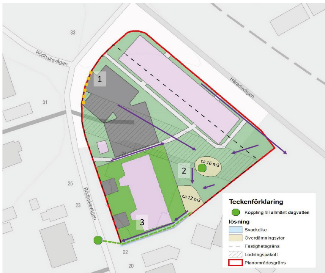
Figur 28. Föreslagna lösningar för skyfallshantering: höjdsättning (1), överdämningsytor (2) och svackdike (3). Orange streckade linjer visar upphöjning av marken för att förhindra ytliga vattenflöden. Lila pilar visar föreslagna avrinningsvägar till överdämningsytor samt skyfallsväg ut från fastigheten ifall översvämningsytornas kapacitet överstigs (Dagvattenutredning, 2024).
