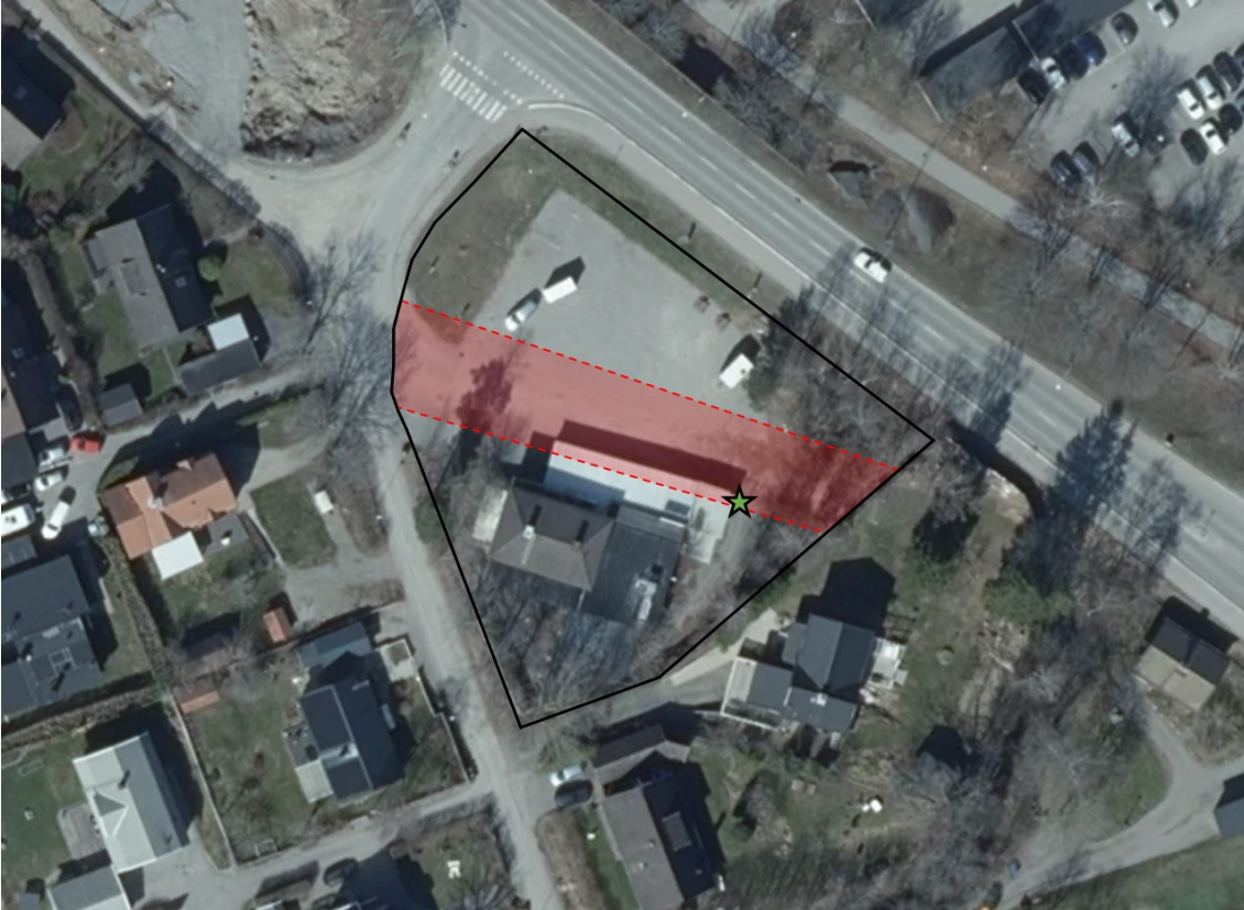
Figur 26 Ungefärligt position av SVOAs ledningspaket genom planområdet markerad i rött. Fastighetens anslutningspunkt för dagvatten markerad med en grön stjärna. Planområdesgräns markerad i svart.
