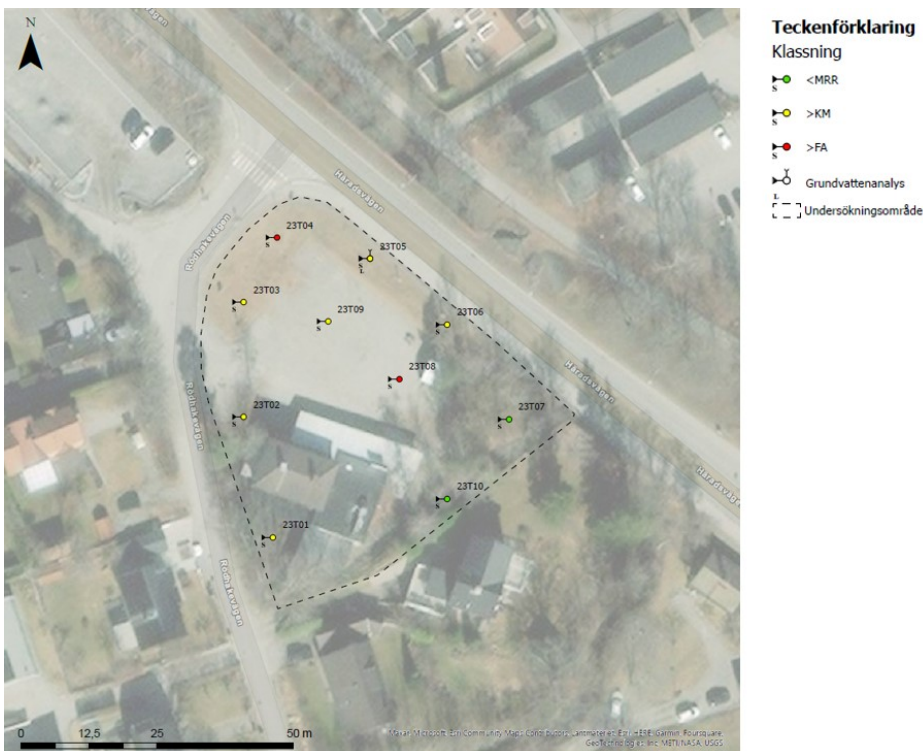
Figur 15: Preliminära resultat från miljöteknisk markundersökning (Tyréns 2023).
