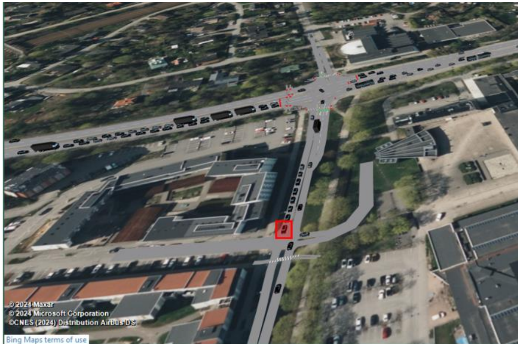
Figur 10: Vänstersvängande fordon på Lännavägen från norr väntar på möjlighet att svänga in mot den nya hallen och hindrar då bakomvarande trafik
