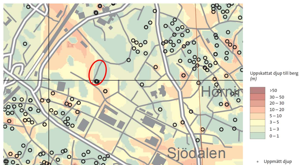
Figur 6.2.2 SGU's jorddjupskarta, där mörkare färger indikerar ett ökat jorddjup. OBS dessa kartor ger en mycket översiktlig bild av markförhållandena.
