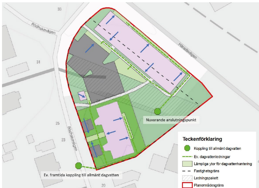
Figur 20. Identifierade lämpliga ytor för dagvattenhantering samt förslag för eventuella dagvattenledningar och anslutning till allmän dagvattenledning. Blå pilar visar avvattningsriktning (Dagvattenutredning, 2024).
