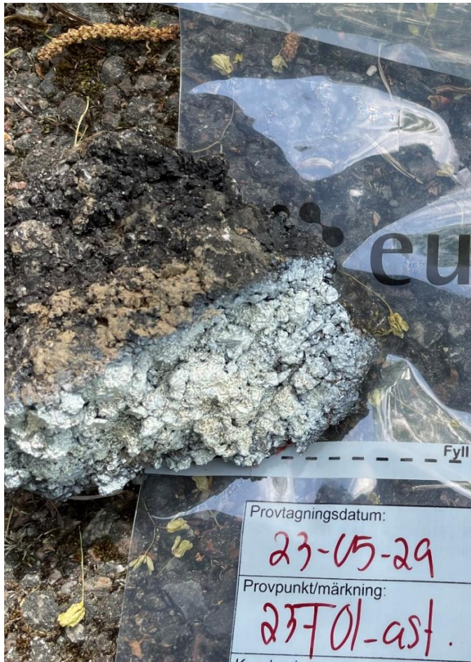
Figur 11. Asfaltsprov uttaget i provpunkt 23T01. Foto visar fältanalys för kontroll av förekomst av stenkolstjära. Foto: Tyréns, 2023-05-29.
