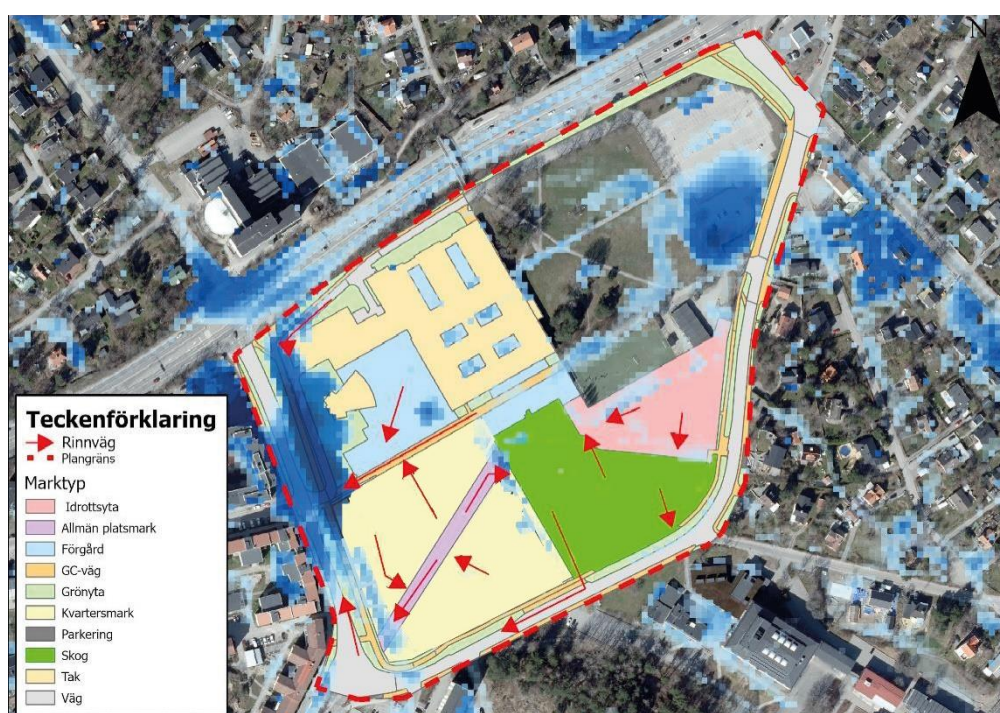
Figur 26. Föreslagna ytliga rinnvägar inom planprogrammet exklusive detaljplan Gymnasiet 4. De röda pilarna inom bostadsområdet visar på hur vatten schematiskt kan avledas.
