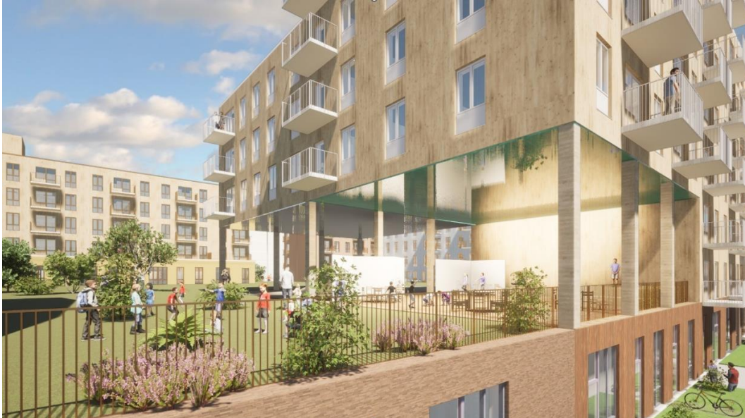
Exempel på volymhantering vid väderskyddad gård under tak där krav om 5 meters fri höjd över ovasida gårdsbjälklag ska tillgodoses. Illustration: ÅWL Arkitekter.
