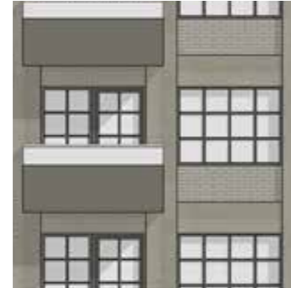
Utsnitt fasad i tegel med relief i betong och industrifönster med tät spröjs
