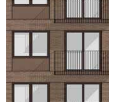
Utsnitt fasad i tegel med fönster utan spröjs
