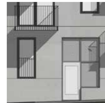
Betongfasad fortsätter ner i sockel
