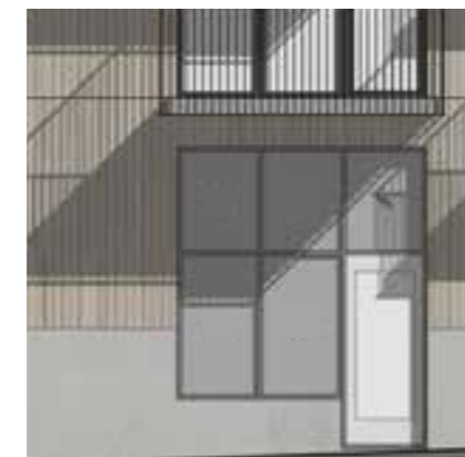
Träfasad möter betongsockel och uppglasad entré
