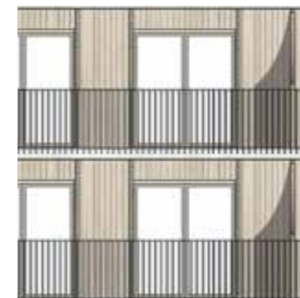
Kontinuerlig balkong med pinnräcke & parfönsterdörrar
