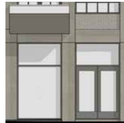
Sockelvåning i betong med markerat Entréparti och generösa fönsterpartier till lokaler
