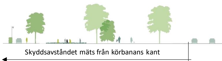
Figur 17. Illustration av hur angivet skyddsavstånd ska mätas.
