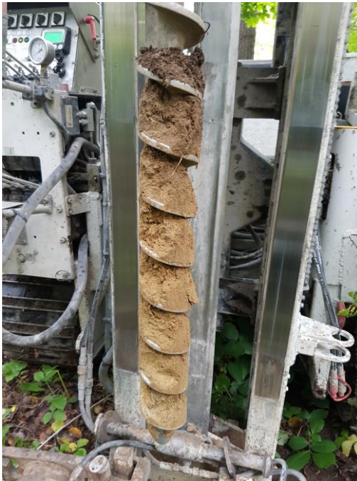
Figur 3. Jordprofil av skruvborr 17S006
