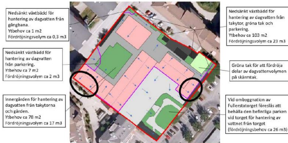
Figur 2. Hur fördröjs dagvattnet vid dom inringade rinnpilarna?
