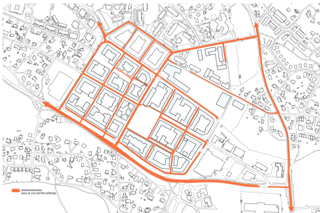
Figur 30. Räddningsvägar vid ett 200-årsflöde. Orange körvägar har maximalt 25 cm vattendjup och är framkomliga för samtliga fordon. (ÅWL Arkitekter, 2024-03-05)
