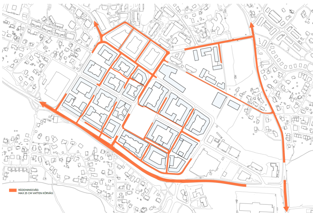
Figur 17. Räddningsvägar framkomliga vid skyfall (100-årsregn, klimatfaktor 1,25). Källa: ÅWL Arkitekter (2024-03-05) baserat på Rambolls skyfallssimulering av planerad höjdsättning.
