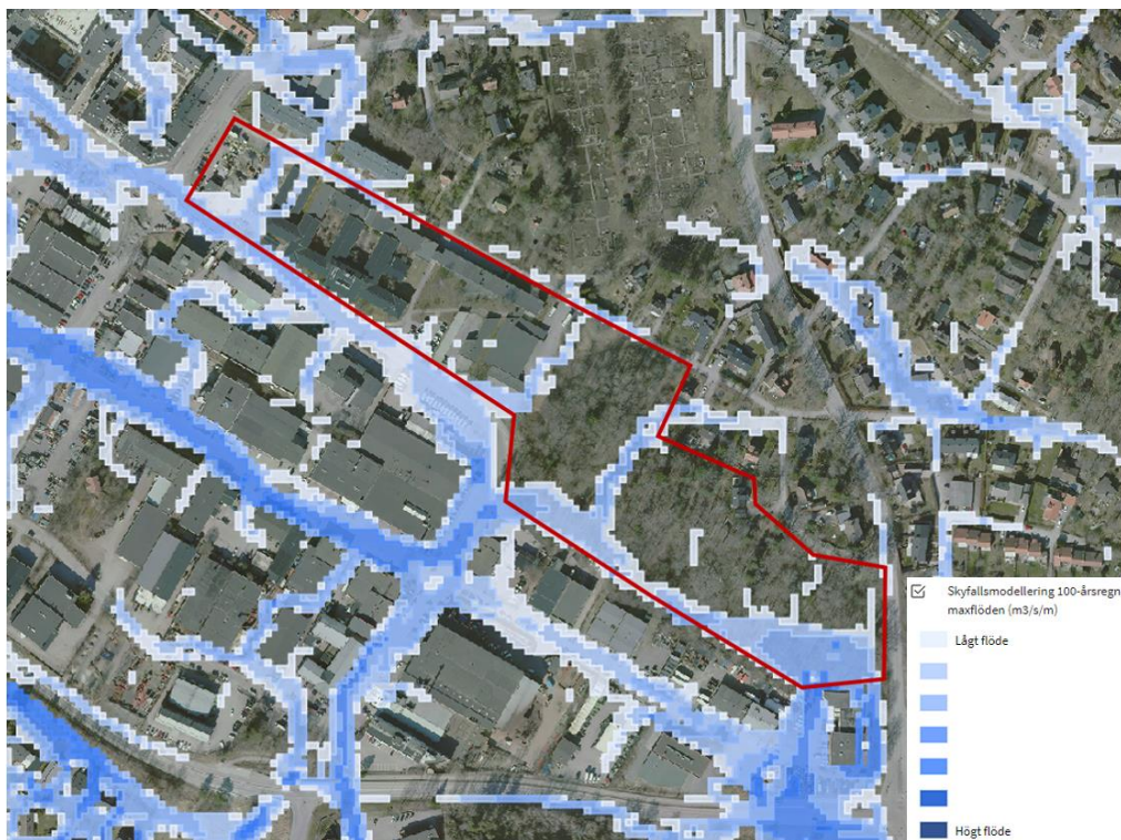
Utdrag från kommunens skyfallskartering som redovisar maxflöden vid ett 100-årsregn. En befintlig flödesväg är identifierad inom planområdets nordvästra del. Planområdets ungefärliga avgränsning inom röd polygon.
