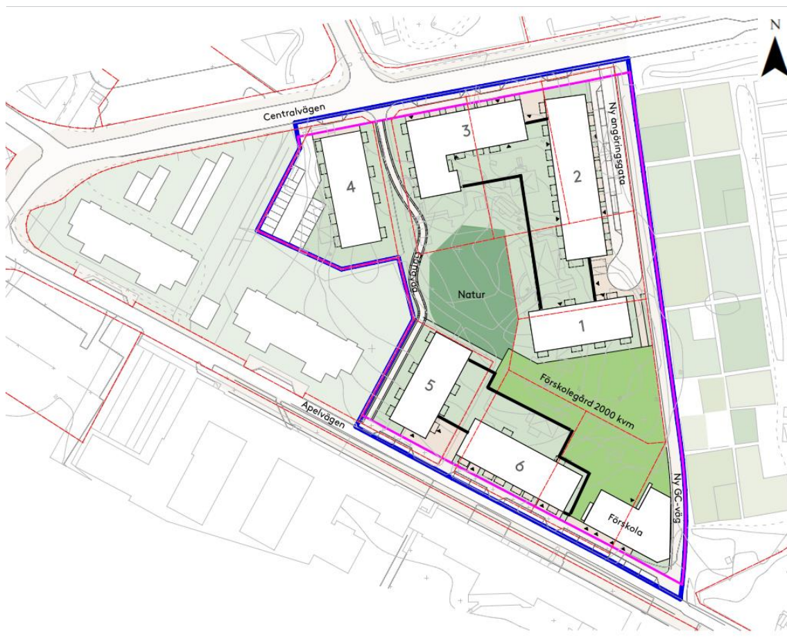
Figur 5. Situationsplan, 2020-10-13. Underbyggd gårdsyta är markerat med svart och lila markering avser utredningsområdet. 11
